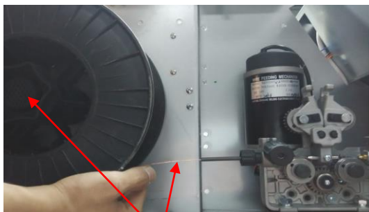
(11) Coloque el hilo en el soporte del carrete. Alimente el hilo por el tubo guía al rodillo.
