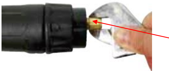
(9) Atornille completamente la tuerca de retención del revestimiento y apriételo.
