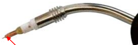
(13) Coloque una punta de aluminio que encaje con el diámetro del hilo.
