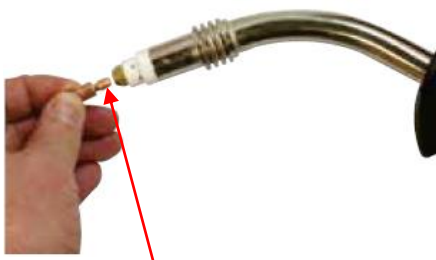
(13) Retire la boquilla de gas y la punta de contacto del extremo frontal de la antorcha
