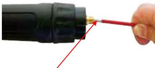
(5) Introduzca cuidadosamente la nueva sirga por el conducto hasta el final para salir del cuello de la antorcha.
