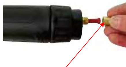
(2) Retire la tuerca de retención.
