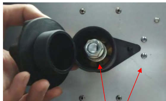
(2) Observe el ajustador del resorte de tensión y el pasador de localización del carrete.
