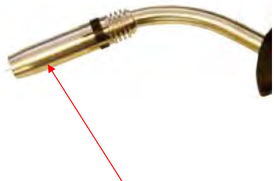
(15) Coloque la boquilla de gas en la parte superior de la antorcha.
