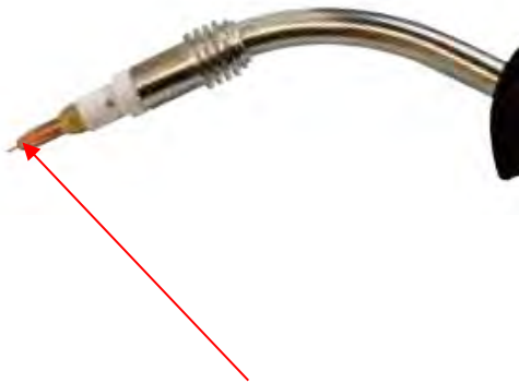
(15) Coloque la punta de contacto del tamaño correcto sobre el hilo y fíjela en el soporte de la punta.
