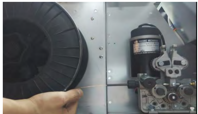
(8) Coloque el hilo en el alimentador. Alimente el hilo a través del tubo guía.
