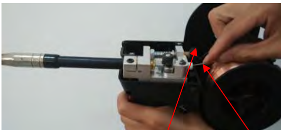
(11) Alimente el hilo a través del rodillo en el tubo guía. Muévelo hacia atrás y sujete el brazo de tensión.
