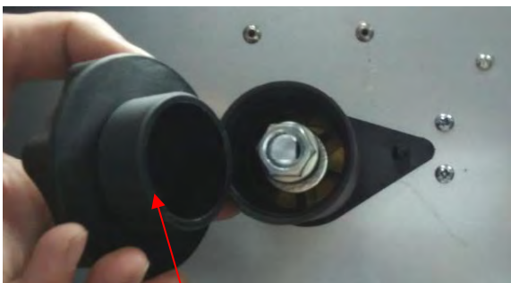
(1) Retire la tuerca de retención del carrete.
