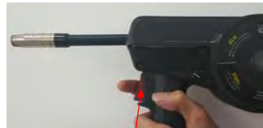
(12) Apriete el gatillo para llevar el hilo por el cuello hasta que salga por la punta.
