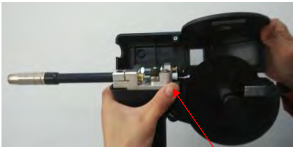
(9) Retire la tapa del carrete apretando el botón
