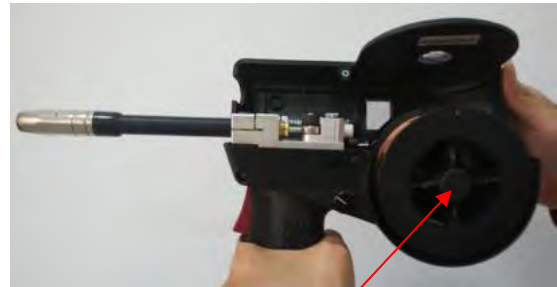
(10) Coloque el hilo en el soporte
