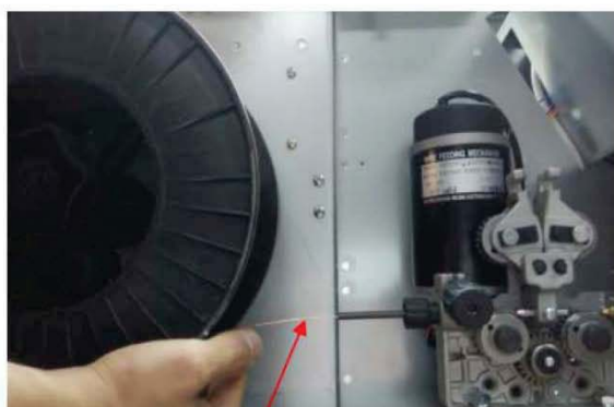
(4) Corte el hilo con cuidado, asegúrese de sostener la bobina para que no se desenrolle. Introduzca el hilo en la guía del alimentador.
