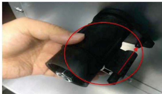
(2) Si utiliza bobinas de hilo de 200mm, instale primero el adaptador. Si utiliza bobinas de hilo de 300mm, ignore este paso.
