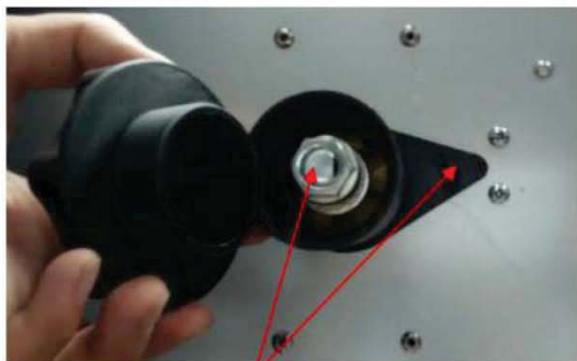
(1) Retire la tuerca de retención del carrete. Tenga en cuenta la tensión del muelle de ajuste y del pasador.
