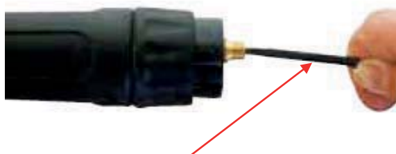
(5) Inserte la nueva sirga cuidadosamente hasta que asome por el cuello de la antorcha. Tenga cuidado de no retorcer la sirga.
