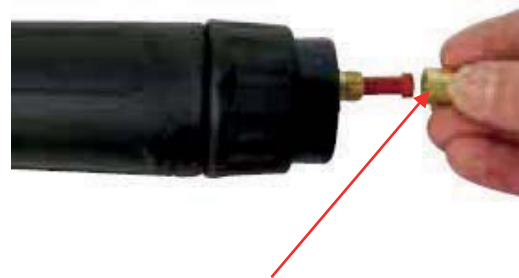
(2) Retire la tuerca de retención de la sirga
