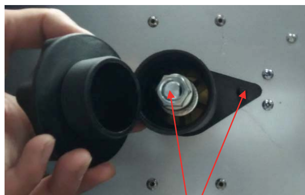
(2) Tenga en cuenta la tensión del muelle de ajuste y del pasador.
