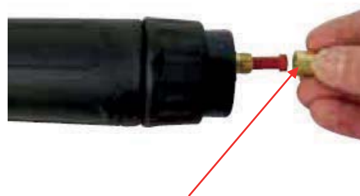
(2) Retire la tuerca retenedora.
