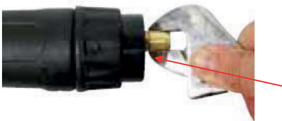
(9) Atornille por completo la tuerca de retención
