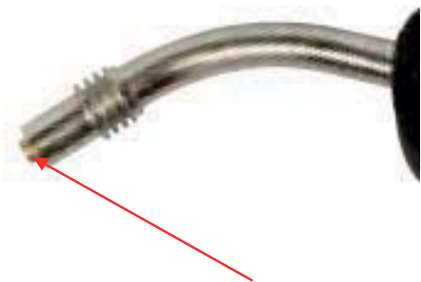
(1) Retire los componentes frontales de la antorcha.
