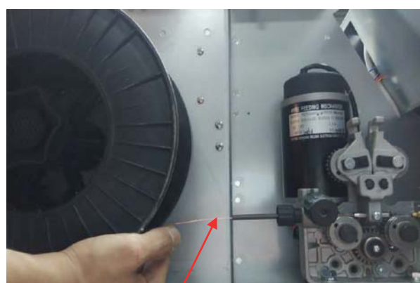
(3) Corte el cable con cuidado, asegúrese de sostener el cable para que no se desenrolle. Introduzca el cable en la guía del alimentador
