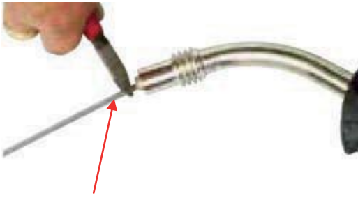
(7) Corte la sirga, 3mm mas allá de la punta de la antorcha.
