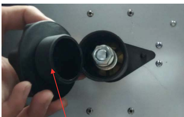
(1) Retire la tuerca de retención del carrete.
