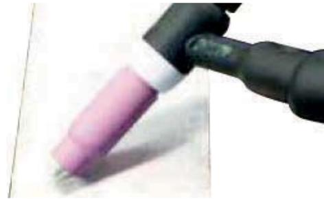
(19) Suelte el gatillo para detener la soldadura.
