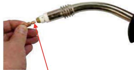
(14) Retire la boquilla de gas y la punta de contacto de la punta de la antorcha.
