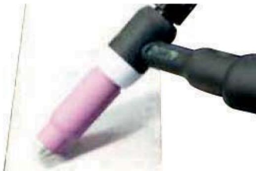
(16) Coloque el borde exterior de la copa de gas en la pieza de trabajo con el electrodo de tungsteno a 1-2 mm de la pieza de trabajo. Mantenga presionado el gatillo de la antorcha TIG para iniciar el flujo de gas.
