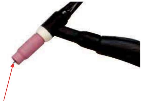
(15) Ensamble las partes frontales de la antorcha TIG, ajustando un tungsteno afilado adecuado para DC
