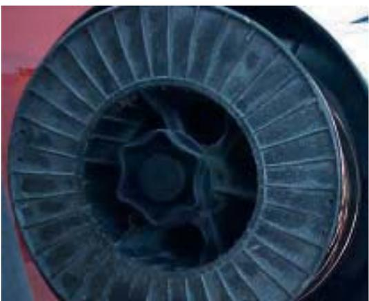
(9) El peso y la velocidad del giro de la bobina crea una inercia que puede hacer que esta se enrede. Si esto sucede, aumente la presión sobre el resorte de tensión dentro del ensamblaje del porta bobina utilizando el tornillo de ajuste de tensión
