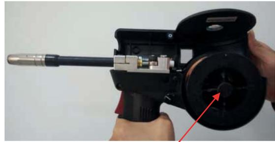
(11) Coloque una bobina de hilo en el porta bobina.
