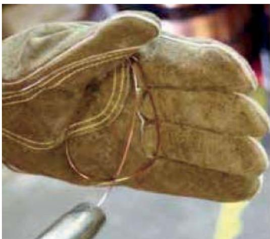
(8) Una simple comprobación de la tensión correcta de la alimentación de hilo es doblar el extremo del hilo y sujetarlo a unos 100 mm de la antorcha. Dejar que se deslice en su mano, debe enrollarse sin detenerse. Si deslízase en los rodillos impulsores, aumentar el tensión de los rodillos.
