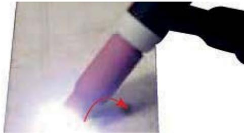
(18) Ahora gire la antorcha en la dirección invertida para separar el electrodo de tungsteno de la pieza de trabajo para crear el arco
